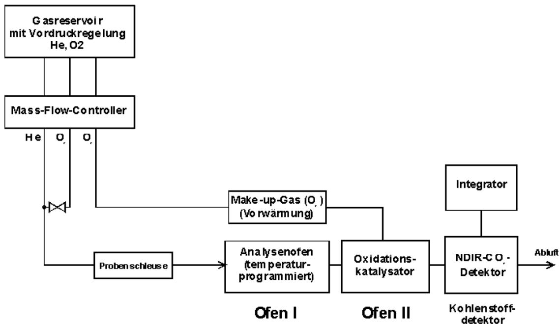
Abb. 1 Fließbild : Diesel-Russ-Analysator, Typ RA 10 m
